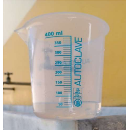
Figura 3: Becker graduado utilizado para a medição da quantidade da água e cálculo das vazões dos aparelhos de ar-condicionado. Fonte: Autores, 2022.
