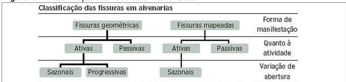
Figura 02. Classificação das fissuras em alvenarias.
