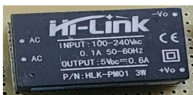
Figura 15 - Mini Fonte Hi-link HLK-PM01 100~240VAC para 5V DC 600mA 3W
