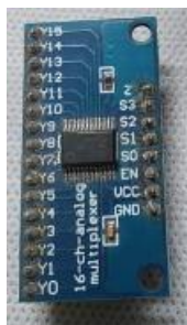
Figura 14 - Módulo Multiplexador Demultiplexador CD74HC4067 16 Canais
