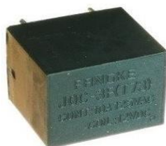
Figura 20 - Relé 5V 10A 5 terminais - 1 pólo x 2 posições T73 - Corrente 10A em 125V
